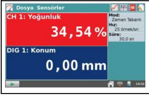
Şekil-6: Işık sensörü önündeki "0.3 mm" giriş aralıklı diske düşen ışığın yoğunluğu.
