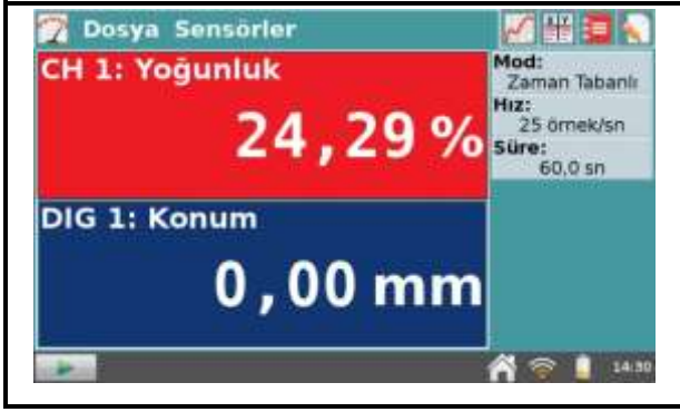
Şekil-20: Işık sensörü önündeki "0.3mm" giriş aralıklı diske düşen ışığın yoğunluğu.
