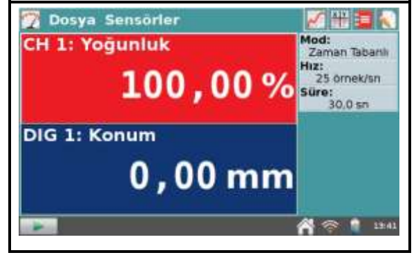
Şekil-5: Lazer ışığının hizalama ve konum sıfırlaması sonrası LabQuest-2 ekran görüntüsü.
