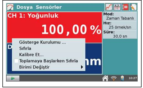
Şekil-19: Konum sensörünün sıfırlama işlemi.
